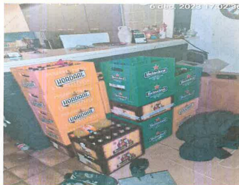
BG / woonkamer/ vuurlast te hoog / door +- 23stuks kratten / voldoet niet.
